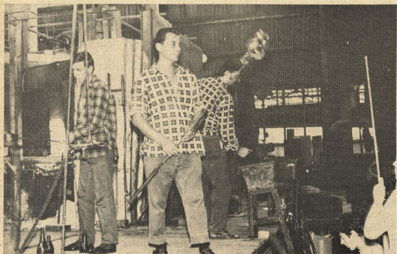
Steklarji-pihalci pri izdelavi izdelkov za razsvetljavo
