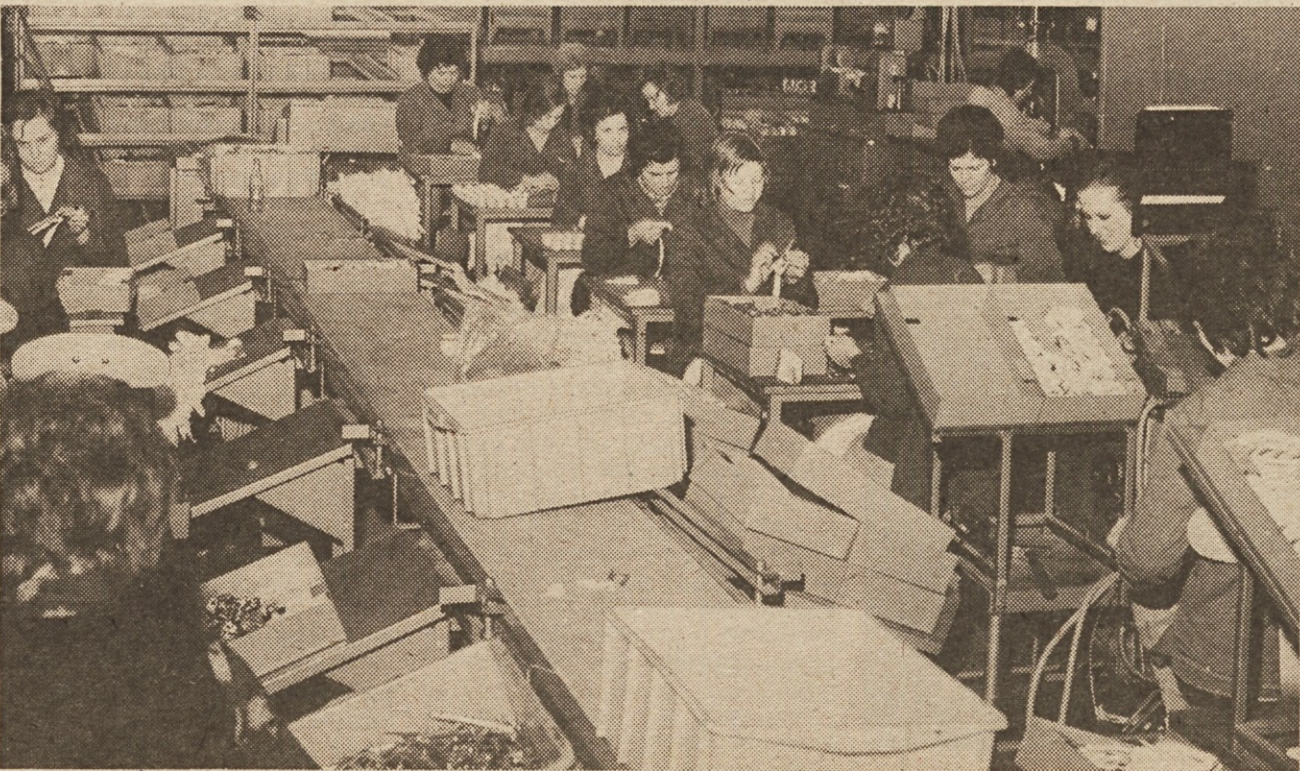
Danes objavljamo na 4. strani reportažo o Industriji avtoelektričnih izdelkov — TOZD Mali zaganjalniki. Posnetek kaže tekoči trak za dokončno izdelavo statorskega navitja za male zaganjalnike.
