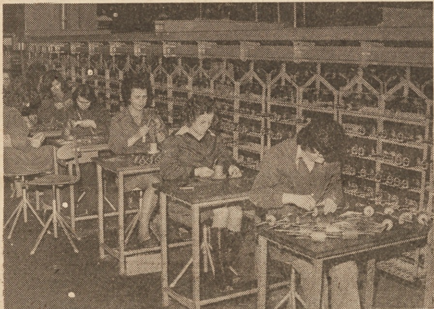
Na tej liniji delavke izdelujejo rotorje za zaganjalnike.
