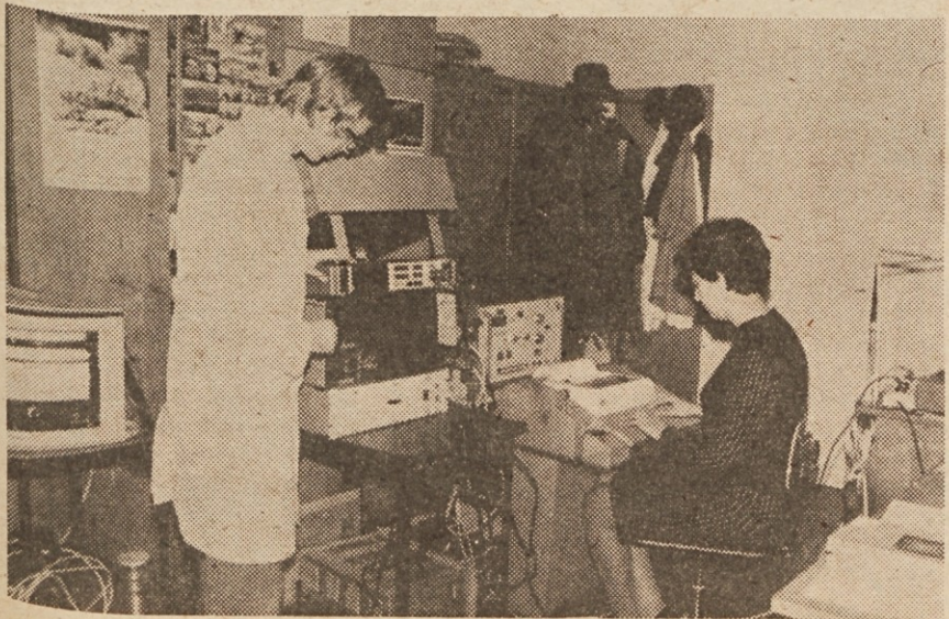
Avtomatski sistem za preizkušanje zanesljivosti uporov.
