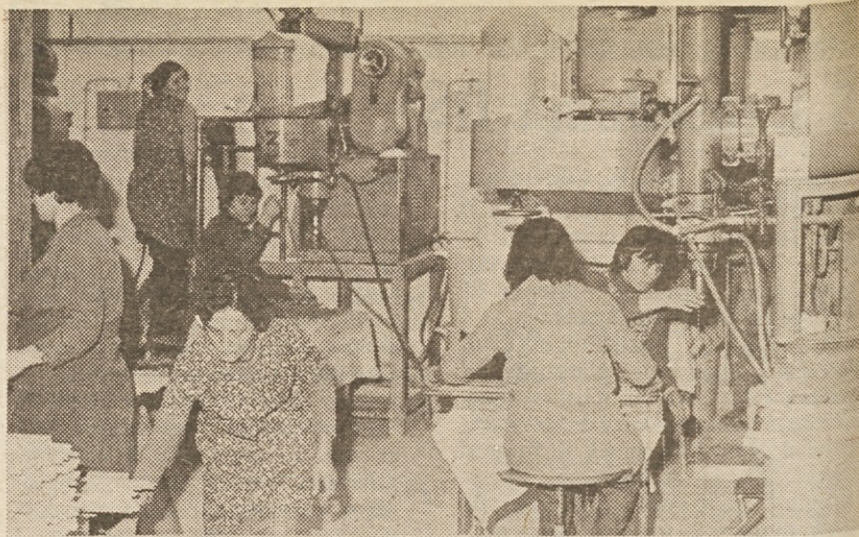
Ekstrudiranje (strojno oblikovanje) keramične mase.
