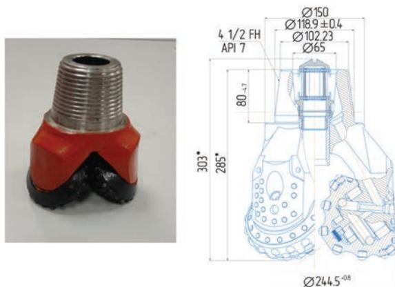
Fig. 2. Roller cone
