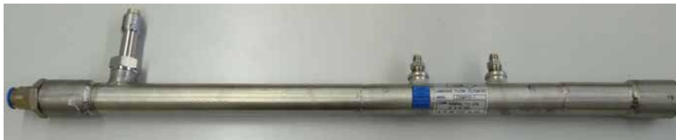
Slika 1: Laminarni tokovni element z vgrajenim temperaturnim zaznavalom (na levi)
