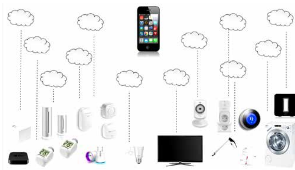
Slika 1 : Nadzor pametnih naprav s pomočjo pametnega terminala in oblaka (povzeto po: https://www.youtube.com/watch?v=DYB2OY4jXnA )
