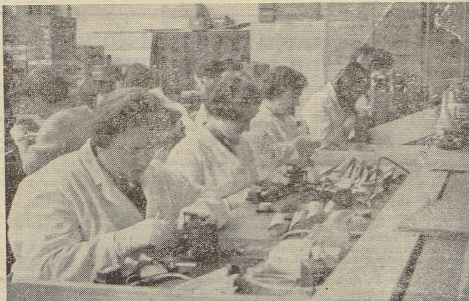
Iz obrata ATN: linija kontaktnih peres za ploščati rele
