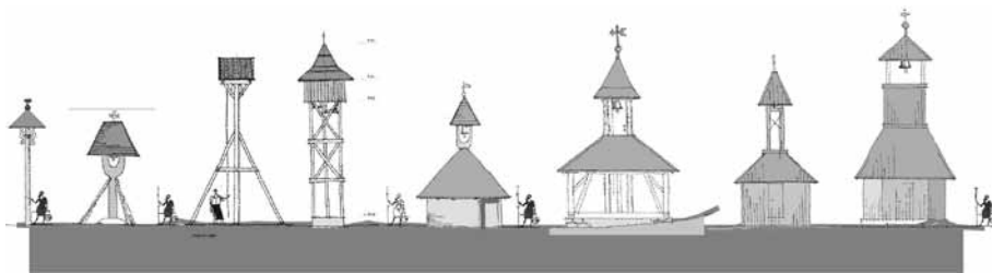
Slika 1: Sistem zvonikov od enostebnega prek dvostebnega brez telesa in s telesom in tristetbnega, štiristetbnega z odprtim ali zaprtim telesom do štiristetbnega z osmerokotnim obitim telesom in s polzaprtim zgornjim delom zvonika.
