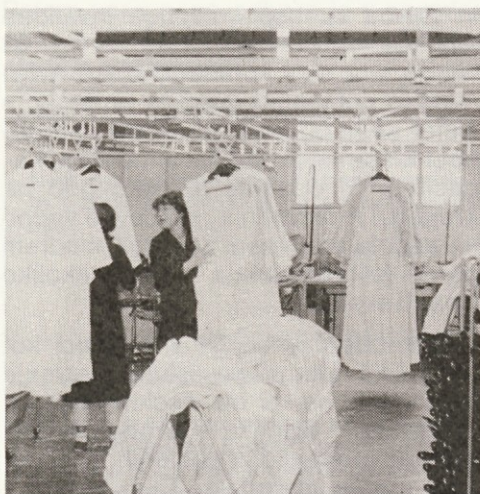
Viseči transport v konfekciji frotirja – korak k humanizaciji in poenostavitvi dela
