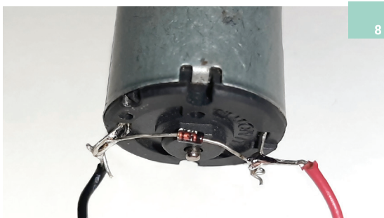
Slika 8 Elektromotor s prispajkano povratno diodo
