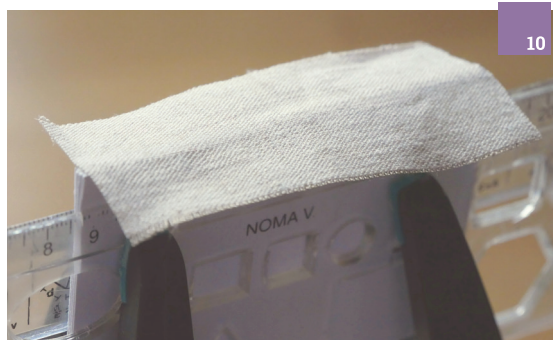
Slika 9 Nanašanje lepila na hrbtnišča snopičev
