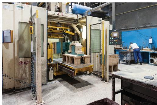
Slika 1: Stroj za izdelavo jeder po postopku Cold-Box
