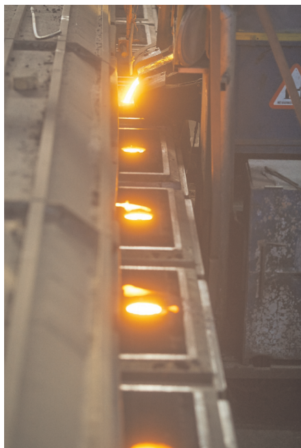
Slika 3: Avtomatska linija za litje v forme (dimenzije forme v mm 1190x990x(300+300))
