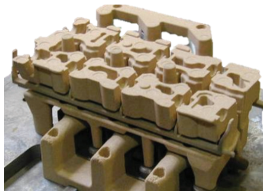
Slika 2: Komplet peščenih jeder za kompleksno glavo valja, izdelan s procesom Rotacast (Gosch in Stika, 2005).
