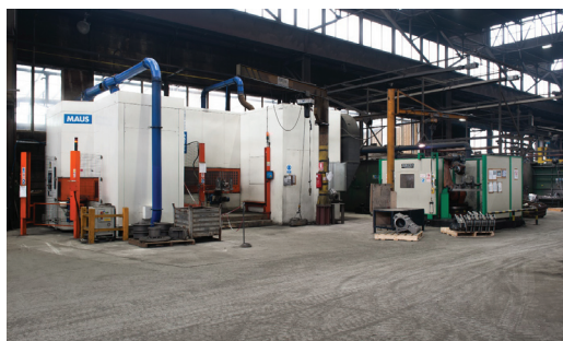
Slika 2: CNC brusilna stroja za čiščenje ulitkov
