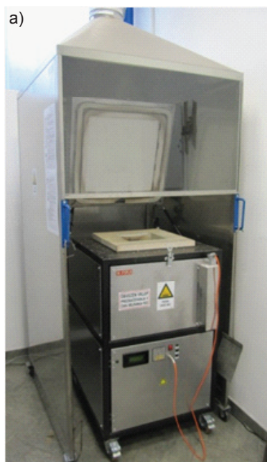
Slika 2: a) Kontrolna metoda za eksotermno-izolacijske materiale EXOPROBE b) s postavitvijo vzorca
