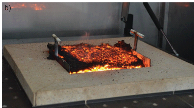
Slika 2: a) Kontrolna metoda za eksotermno-izolacijske materiale EXOPROBE b) s postavitvijo vzorca
