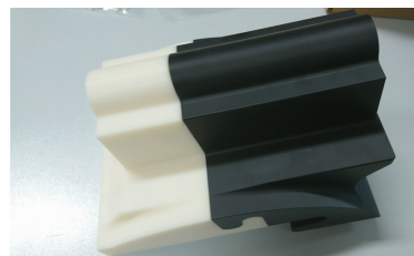
Slika 6: Primer izdelave 3D tiskanih vložkov za integracijo v livarska orodja
