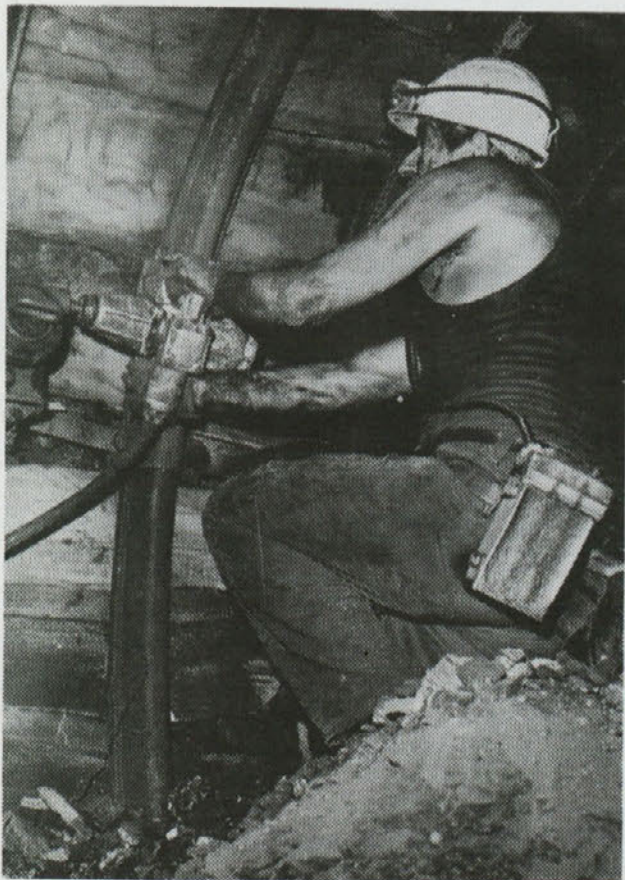
Delo z Brezovnikovo racionalizacijo - s strojčkom za odvijanje matic objemk ločnega podporja
