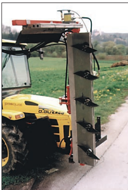
Rotacijski vršičkar za zeleno rez v vinogradih
