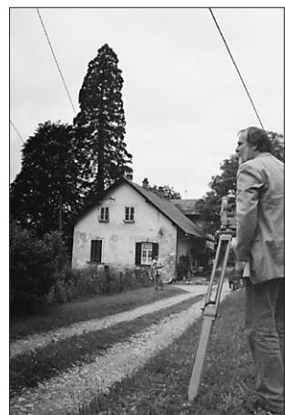
Orjaška sekvoja v Orešju med merjenjem višine s pomočjo prizme in teodolita
