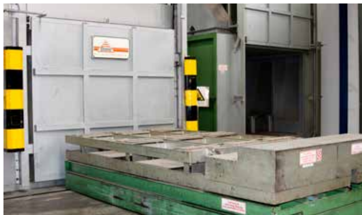
Rekristalizacijsko žarjenje v komorni peči
