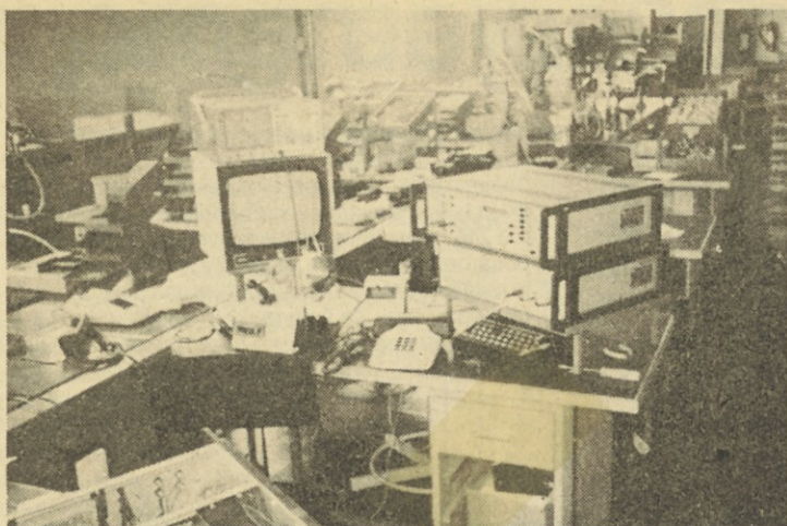
Kontrolno mesto sestavljenih telefonskih aparatov, opremo je postavila Iskra.
