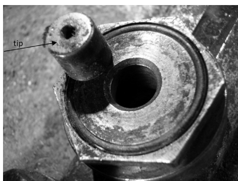
Figure 2: Drawing die (matrix) with a tip (pressure type) Slika 2: Orodje za vlečenje (matrica) s konico (tlačne vrste)
