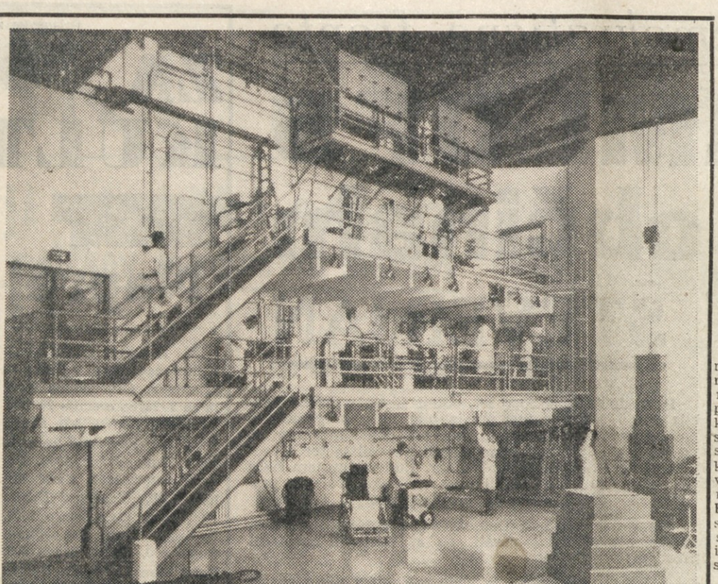
V ATOMSKEM LABORATORIJU Na sliki vidimo del atomske baterije, na katerem je apliciran reaktor. Komisija za atomsko energijo v ZDA je dovolila, da se znanstveniki pri svojih raziskovanjih odsej lahko okorščajo z reaktorjem, ki proizvaja nevtrone. Kemiki in fiziki na prvem balkonu merijo energijo nevtronov, ki izhajajo iz atomske baterije
