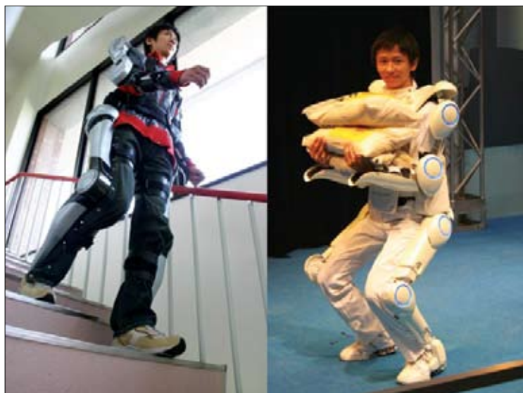
Hodeči človek HAL je skeletna konstrukcija, ki pomaga pri gibanju in dvigovanju predmetov ljudem z ovirano fizično sposobnostjo.
