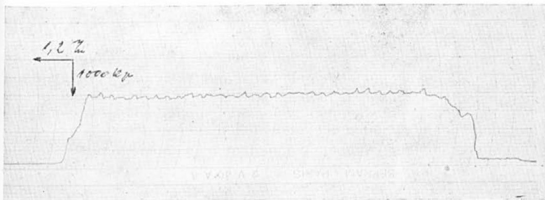
Slika 53 — diagram sil pomika pri vrtanju s svedrom 40 Ø, s = 0,5 mm, v = 6,3 m/min, mat. C 60 (I)
