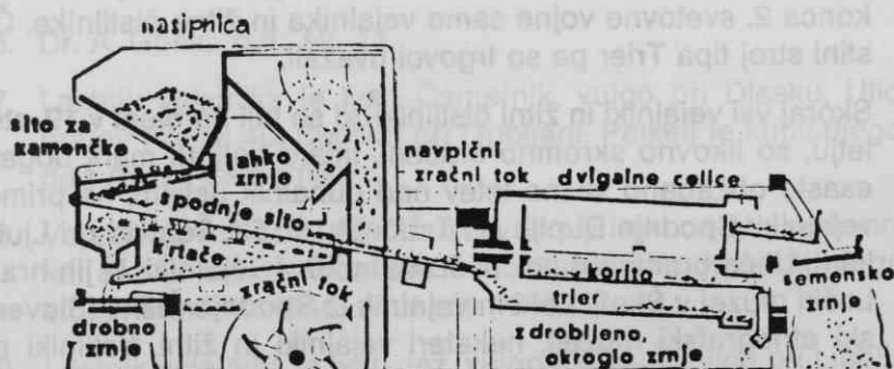
Sl. 20: Sestavljeni žitni čistilnik s celičnim Trierjem (povzeto po Raoul Jenčiču)
