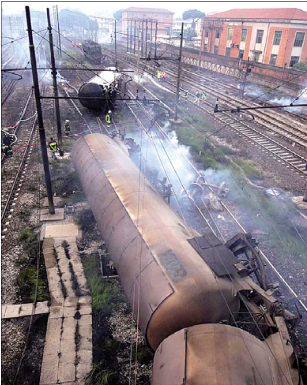
Prevrnjeni vagoni s cisternami avtoplina, ki je bil vzrok za razdejanje in žrtve
