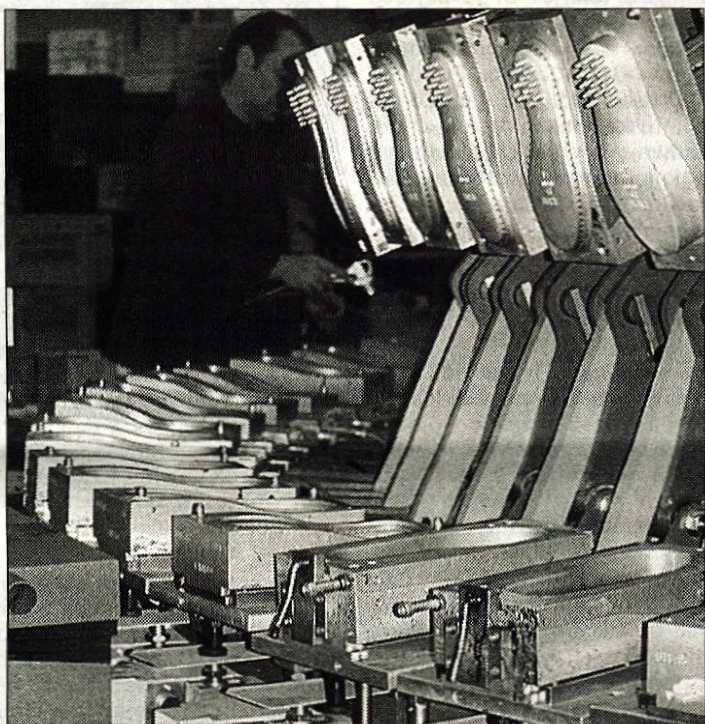
V tržiškem PGP izdelajo 28 tisoč parov podplatov dnevno. S pomočjo novega, trenutno najsodobnejšega stroja za izdelovanje poliuretanskih podplatov bodo izboljšali kvaliteto izdelkov, omogoča tudi izdelovanje podplatov iz kombinacije različnih materialov.
