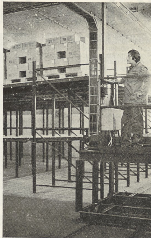
Smo v drugi etaži, ki je namenjena vskladiščenju in prevzemanju gotovih izdelkov. Po paletnem dvigalu prihaja blago, ki se avtomatsko vklada v pretočne regale. Se en zanimiv podatek: v tem skladišču je prostora za 1110 palet. Delo Franca Baligača ni težko, saj mora le pazljivo ravhati z napravami.
