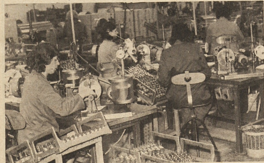
Slika nam kaže navijanje rotorskih in statorskih navitij v montaži.
