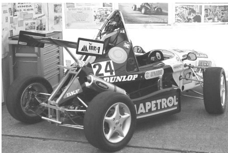
Sl. 2. Motor Honda 600 cm 3 stoji povprek v zadku dirkalnika
