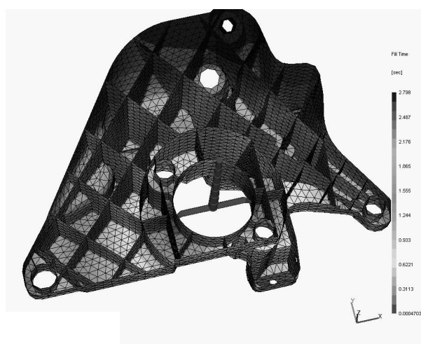
Sl. 4. Simulacija časa zapolnjevanja orodja pri brizganju in analiza izdelka z MKE
