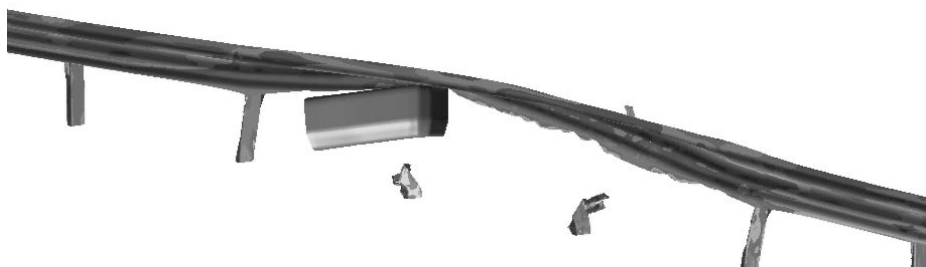
Sl. 8. Deformacija ograje s profilom D
