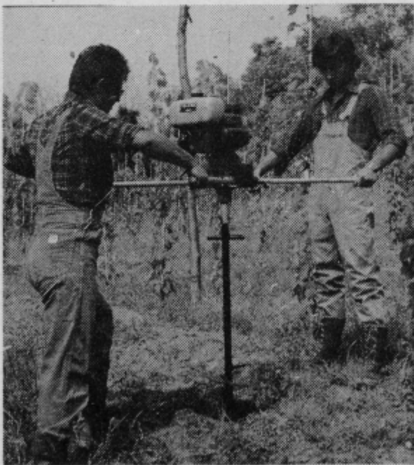
Motorni vrtalnik je idealen pripomoček za vrtanje lukenj v zemljo pri delu v poljedelstvu, vinogradništvu, vrtnarstvu, gradbeništvu, šadjarstvu in gozdarstvu. Primeren je za delo na terenih, ki niso dostopni težji mehanizaciji.
