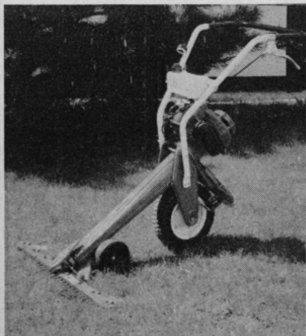
Samohodna kosilnica ima koso, primerno za košnjo vsakovrstne trave. Spodaj nameščena kosa omogoča košnjo prav ob zidu in ob drevju, širina grebena pa omogoča hitro košnjo tudi na večjih površinah.
