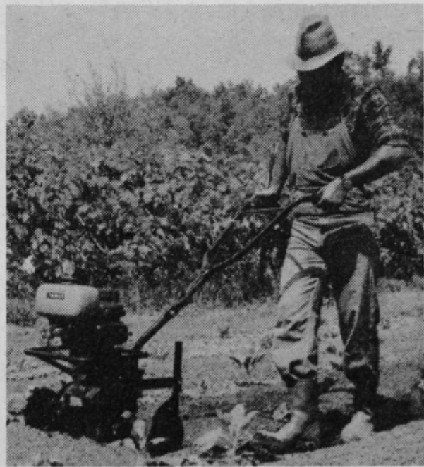
Motorni okopalnik, namenjen predvsem drobnim kmetijskim proizvajalcem in vrtnarjem. Njegova uporabnost je vsestranska, delo z njim pa je enostavno in ni utrudljivo. Največkrat ga uporabljajo za dopolnilno obdelovanje zemlje.
