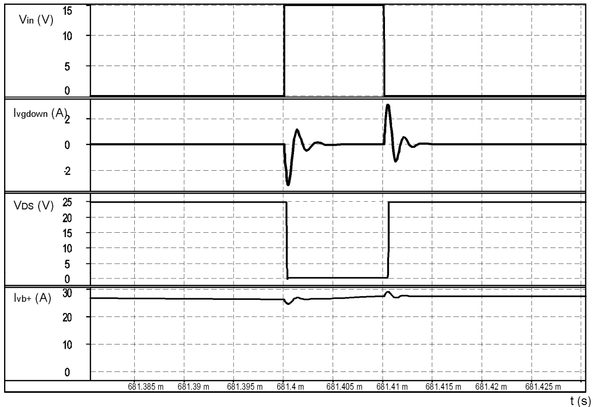
Slika 36: Signali simulacije z bremenom, priključenim med pozitivnim potencialom napajalnega vira in terminalom faze simulacijske sheme na sliki 35
