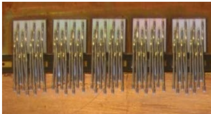
Slika 51: Priključitev vzporedno vezanega sklopa petih MOSFET tranzistorjev
