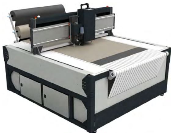
Slika 4: FastSewn, sistem za digitalno krmiljeno avtomatsko šivanje in rezanje tekstila [10]
