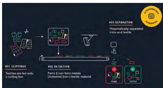
Slika 6: Postopek ločevanja netekstilnih in tekstilnih komponent starih oblačil [12]
