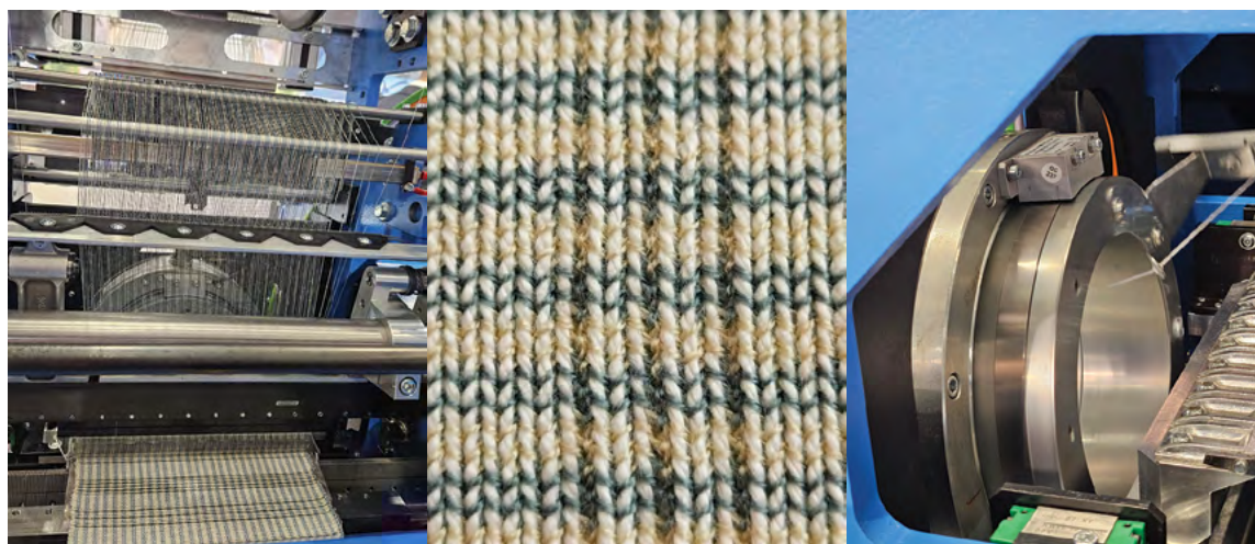
Slika 9: Inovativni snutkovni pletilnik z vnašanjem votka s pomočjo rotirajoče zanke
