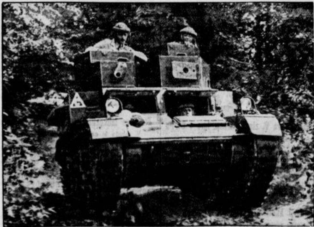
V ameriških manevrih v Virginiji je prišel na teren tudi nove vrste tank s »dvojčkami«: s dvema stolpoma, v katerih sta dve strojnici. Tanki dosežejo hitrost 90 km na uro.
