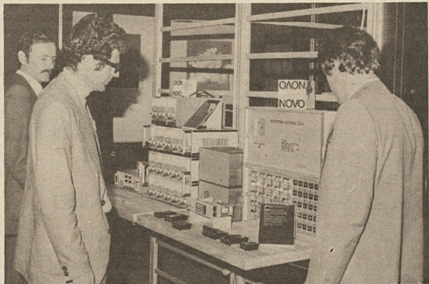
Registrirnik delovnega časa na desni, na levi pa polprevodniški stabilizirani usmernik v modulni izvedbi z zvezno regulacijo napetosti in toka.
