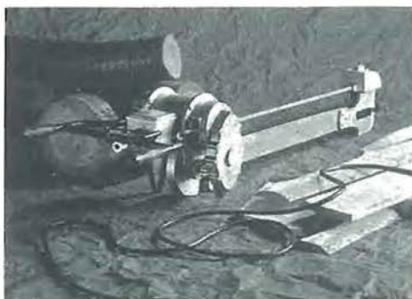
Slika 1: Dvoročna motorna žaga – model iz začetka 60 let dolge razvojne poti motornih žag
