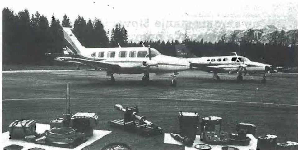
Slika 1: Letala in aerosnemalna oprema. Obe letali (Piper, Cessna) sta prirejani za aerosnemanje in imata v dnu trupla posebno odprtino za namestitev fotogrametrične kamere. Izmenljivi objektivni z maso približno 50 kg) imajo goriščno 152 mm (90 - širokokotni) in 305 mm (60 - normalnokotni).
