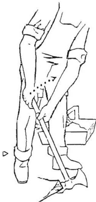
b) Prečni zasek naredimo z listom rovnice. Toporišče dvignemo.
