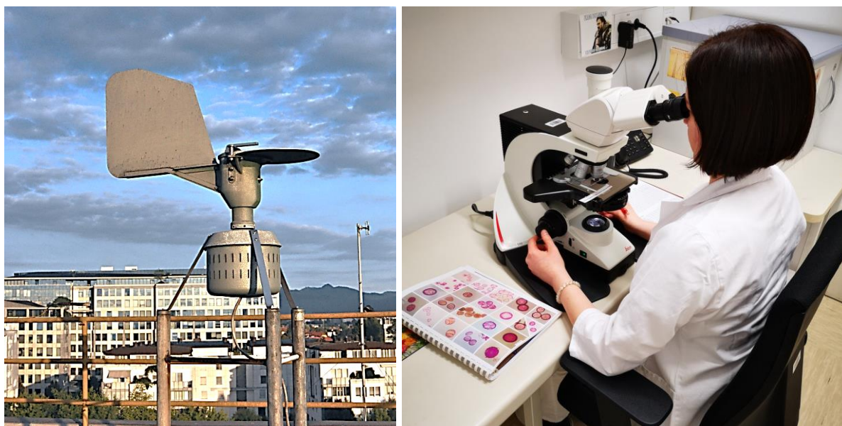
Slika 15. Vzorčevalnik cvetnega prahu Hirstovega tipa (levo), analiza vzorcev s svetlobnim mikroskopom, štetje in določanje vrst cvetnega prahu (desno); (Foto: Andreja Kofol Seliger) Figure 15. Hirst type volumetric spore sampler (left), sample analysis by microscopy, pollen identification and enumeration (right); (Photo: Andreja Kofol Seliger)
