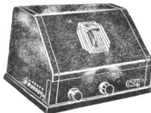
Štirielektronski aparat U 4 S z elektronkami z zamreženo anodo. Aparat za kratke, normalne in dolge valove od 15—2000 m; izhodni transformator za magnetične in dinamične zvočnike, tok za magnetiziranje elektrodinamičnega zvočnika itd. Sprejema ca 100 postaj na zvočnik
