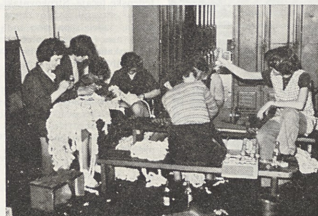
Čistilna skupina čisti in maže raztezalne valjčke v garderobi predilnice 4. Prostor za čistilno skupino bo potrebno s predelno steno ločiti od garderob.
