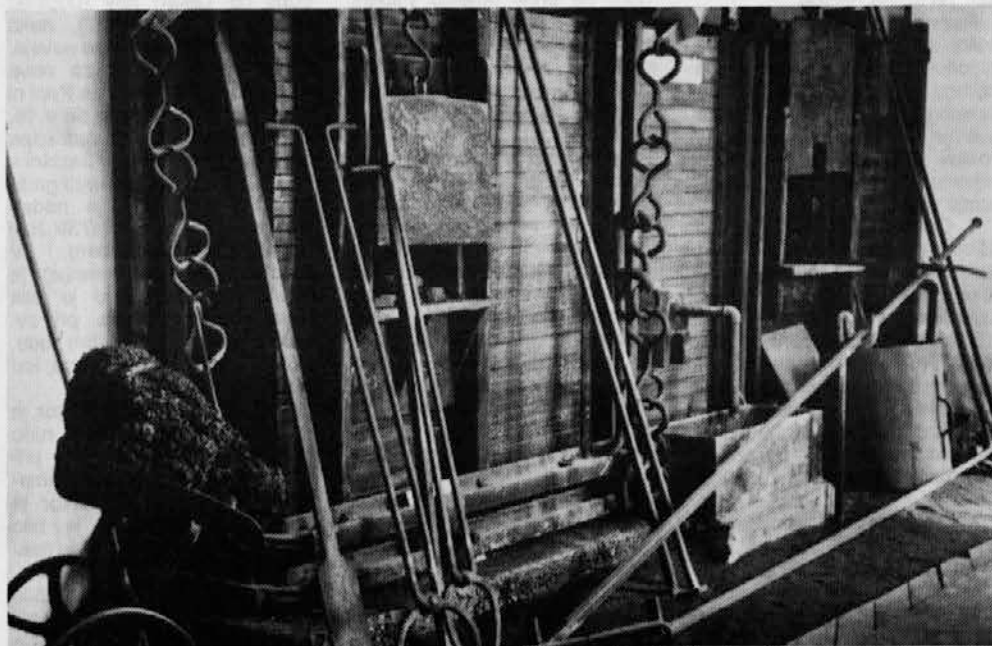
Pudlovka v Delavskem muzeju Ravne na Koroškem. V taki peči so grodelj (surovo železo) pudlali. Surovo železo so segreli toliko, da je nastala mehka žareča greda, ki so jo mešali in gnetli. Ko je dozorela, so jo prevajali na poseben voziček, jo stisnili in kovali. Tako so prišli do pudlanega jekla. Prve pudlovke v Mežiški dolini so postavili na Prevaljah 1835. in na Ravnah 1852. leta.
