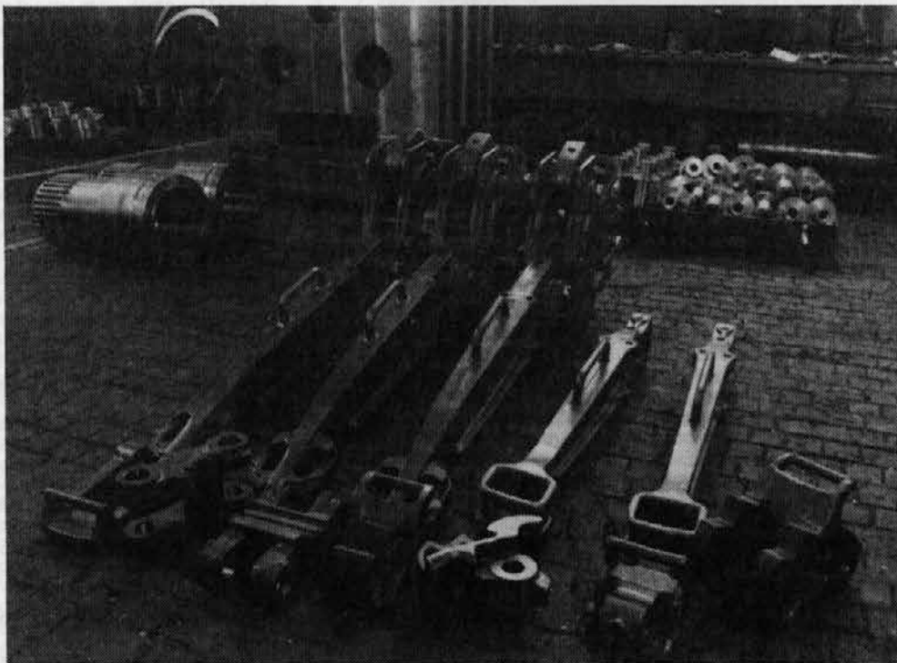
Cevne klešče (izdelek Železarne Ravne) za cevnice na naftnih vrtinah
