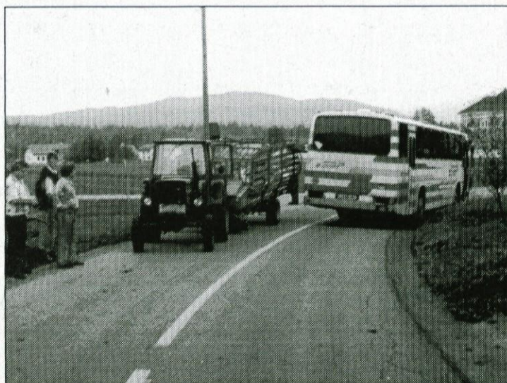
Neppravilno zaprta zadnja stena nakladalke je na avtobusu povzročila škodo.
