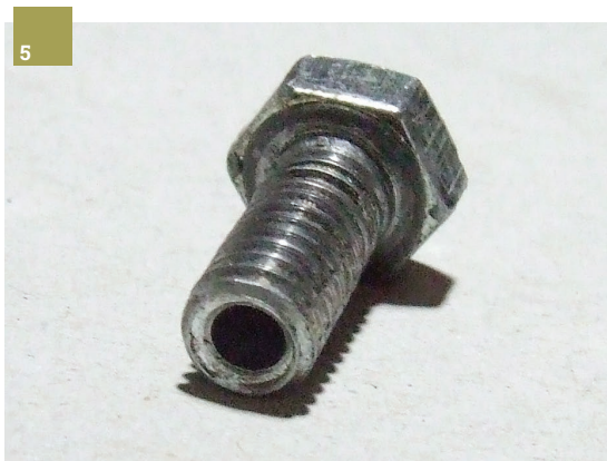
Luknja skozi vijak mora biti natanko na sredini vijaka in vzporedna z njegovo osjo.
