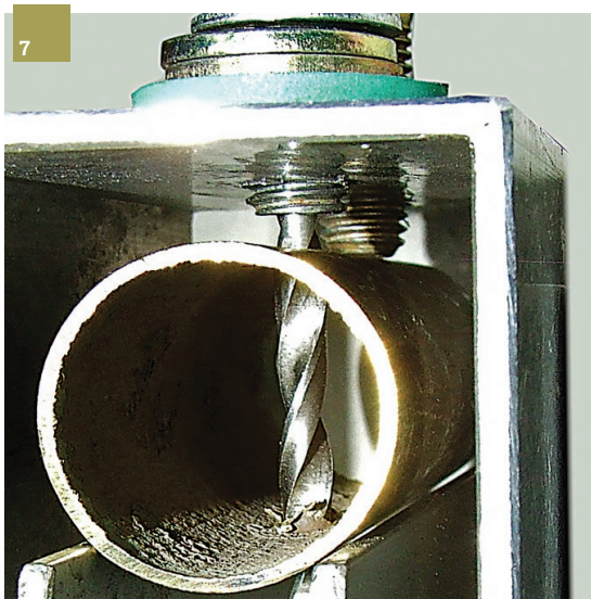
Med koncem vodila za sveder in cevjo mora vedno ostati vsaj 2 mm špranje, ki omogoča izmet materiala, izvrtanega iz obdelovanca.
