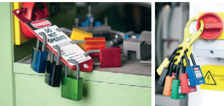
» Slika 2 in 3: Skupinski adapter se namesti namesto obešanke direktno na energetski izolator, nanj gre do 6 obešank. Za večje število se lahko doda poljubno število adapterjev.
