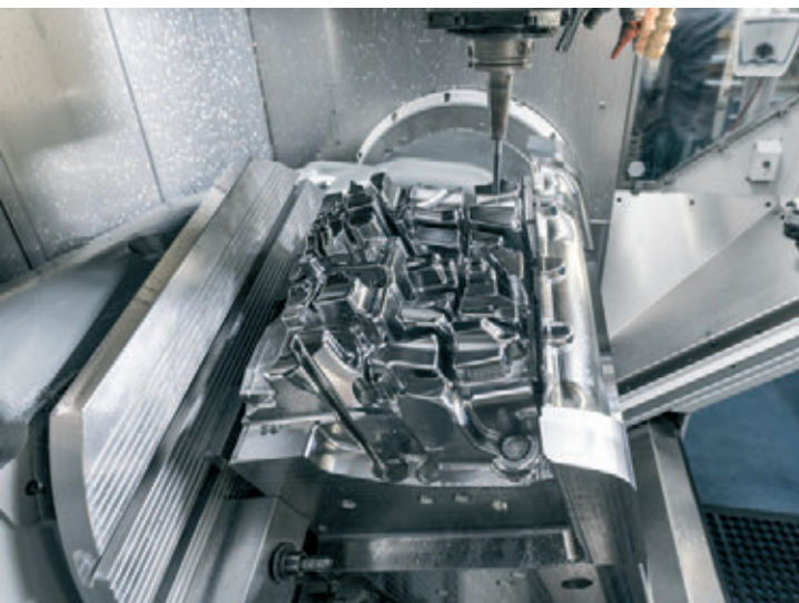
» Obdelovalno območje stroja C 52 U z veliko nihajno rotirajočo mizo premera 700 mm in nosilnostjo 2000 kg; tu je nameščen veliko osnovno orodje obdelano s 5-osno strategijo.
