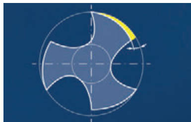
»Optimizirana geometrija vodilne ploskve zagotavlja stabilno obdelavo širokega spektra materialov. Zadnja stran zagotavlja lomljenje in glajenje odrezkov.
