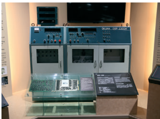
» Eden prvih računalniško vodenih NC-krmilnikov. © Okuma
