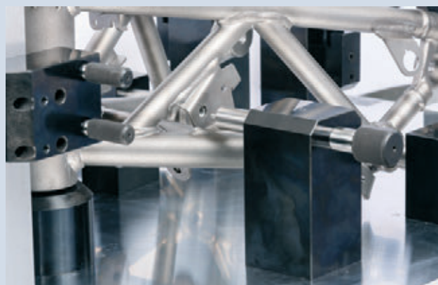
» Kontrolno ravnalna priprava za ogrodje motorja.
