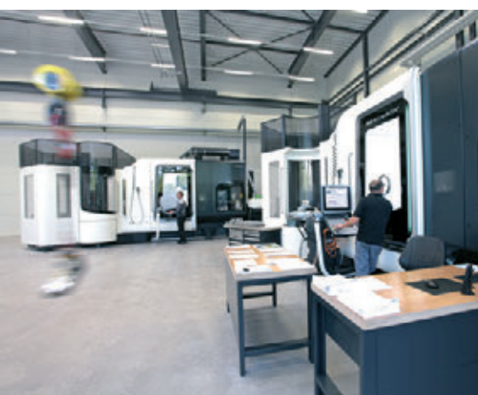
» Obdelovalna stroja DMC 80 U duoBLOCK, ki sta opremljena z rotacijskim paletnim zalogovnikom RS 12 z do 12 paletami naenkrat, lahko učinkovito obdelujeta 24 ur na dan.
