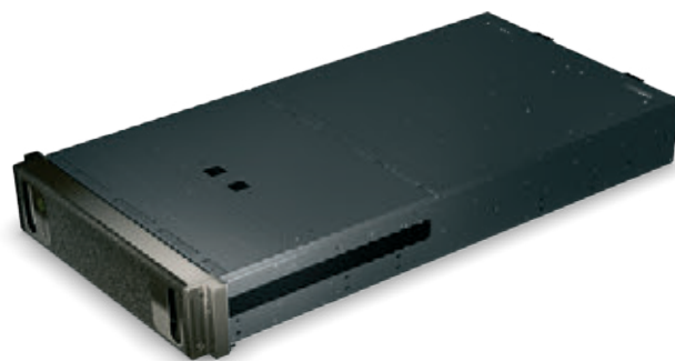
» Sistemske specifikacije NVIDIA DGX-1: GPU 8X Tesla V100, zmogljivost: 1 petaFLOP, GPU spomin: 256 GB, CPU: Dual 20-jedrni Intel Xeon E5-2698v4 2.2 GHz, NVIDIA CUDA jedra: 40.960, NVIDIA Tensor jedra: 5.120, pomnilniški sistem: 512 GB 2.133 MHz DDR4 RDIMM, shramba: 4X 1.92 TB SSD RAID 0, omrežje: Dual 10 GbE 4 IB EDR. Foto: Nvidia
