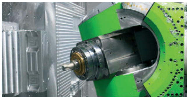
»V kombinaciji so horizontalni obdelovalni center, 3-osna frezalna glava in SPM-Rough ISO frezalo za obodno frezanje dosegli najboljše rezultate.
