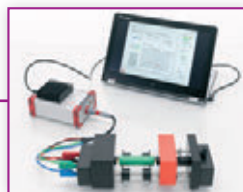
138 Merilni vpenjalni sistem za merjenje impedance baterijskih vložkov
