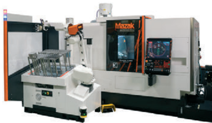
» Stružni center QUICK TURN 250MY in robotska rešitev TA-12.
