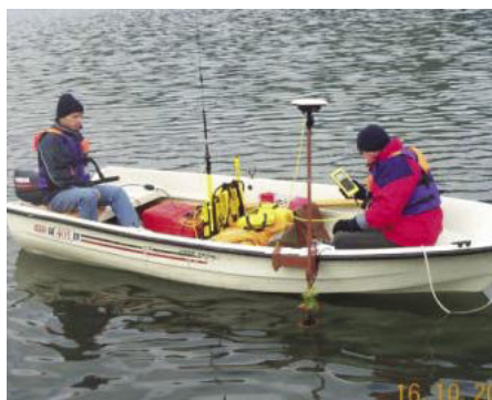
Slika 8 • Merjenje na jezeru (levo), 3D-model dna jezera (sredina), batimetrična karta Velenjskega jezera (desno) (Potočnik, 2013)
