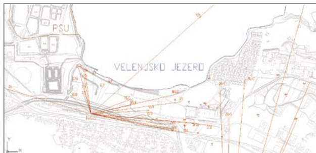
Slika 6 • Shema opazovalne mreže Pesje (rdeče črke GL2, VI/3 ... predstavljajo opazovalne točke)
