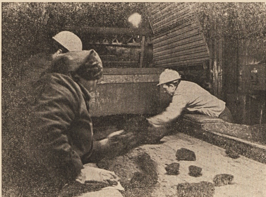
Na separaciji Trbovlje — ročno odbiranje jalovine s transportnega traka.
