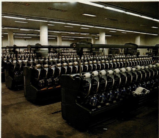
Del previjalnice z novimi križno previjalnimi avtomati Savio
