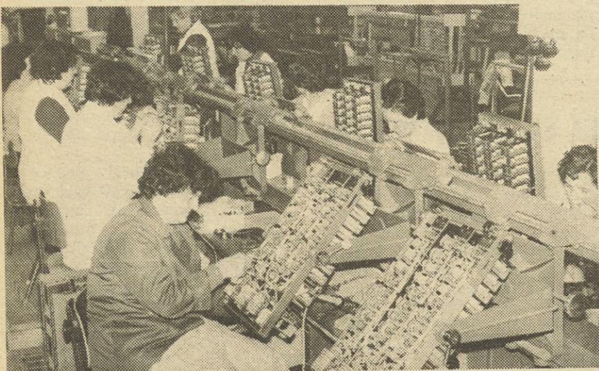
Spajkanje relejnih enot na Blejski Dobravi.
