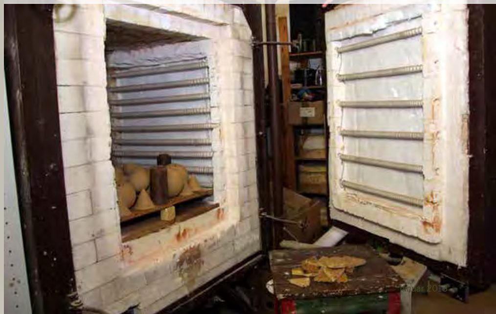
Visoka kakovost izdelkov je zagotovljena z žganjem pri visokih temperaturah čez tisoč stopinj Celzija
