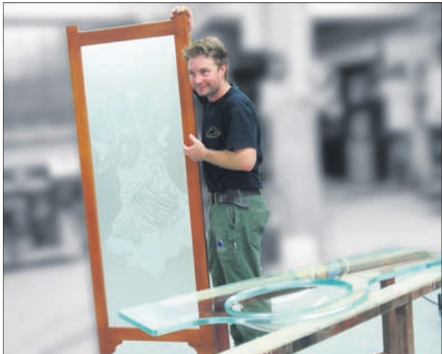
Mitja Lukanc z motivom angela, izdelanega v tehniki peskanja in jedkanja stekla. V ospredju polizdelek steklenega umivalnika.
