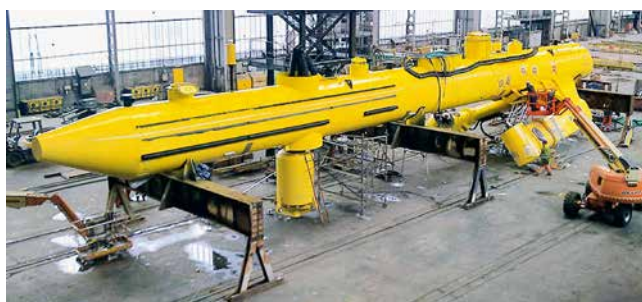
» Konstrukcija elektrarne je bila razvita za posebne zahteve delovanja v Severnem morju
