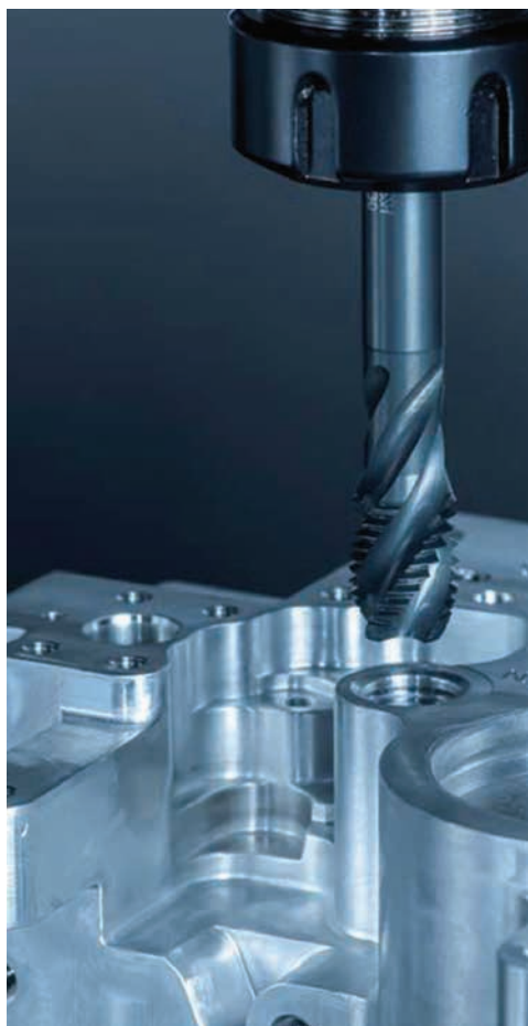
» Navojni sveder A-SFT z variabilno glavno vijačnico optimizira oblikovanje in odstranjevanje odrezkov.
