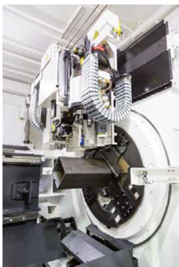
» Mazak 3D Fabri Gear 400 II lahko reže kvadratne cevi s stranico do 300 mm in okrogle cevi premera do 406 mm.
