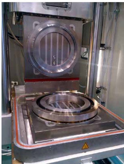
» Magnetna vpenjalna plošča Römheld Hilma M-Tecs na DKT na stiskalnici za gumo proizvajalca Wickert (foto: Römheld)
