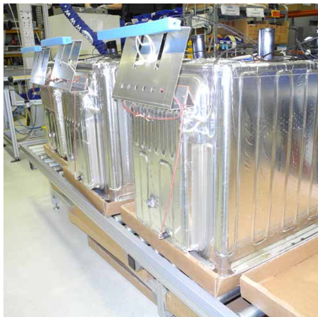
» Po montaži grelnih folij, senzorja in držala čaka notranji vsebnik da se nanese izolacija in preko vsega montira zunanje ohišje (Slika: ROEMHELD).
