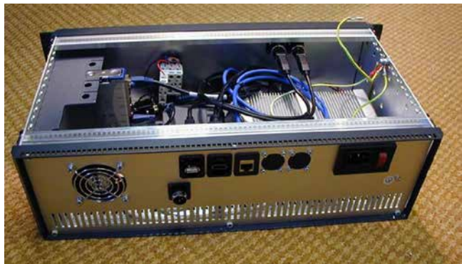
» Slika 2. Sistem CompactRIO (levo), vgrajen v enoto
