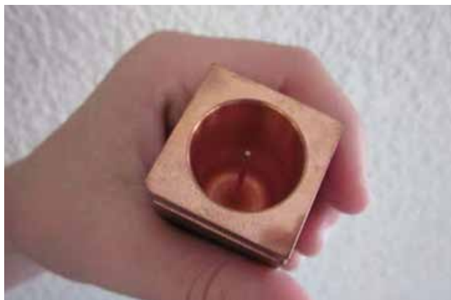
» Slika 11: Tankostenski cilinder izrezkan iz bakra
