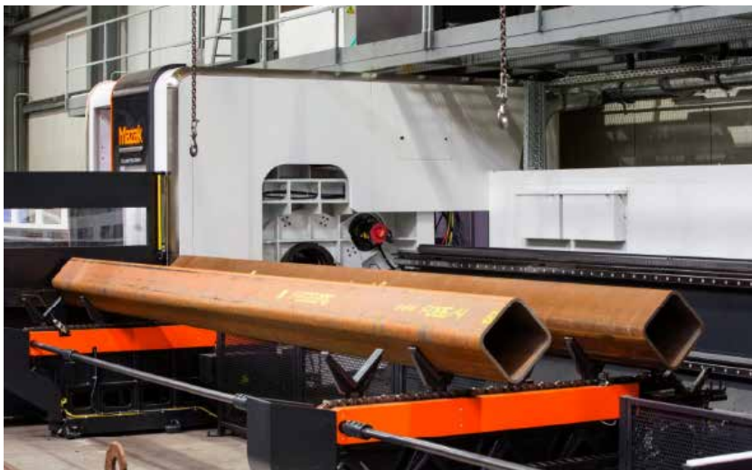
» Nemško podjetje Elting Geräte und Apparatebau GmbH uporablja laserski rezalni stroj Yamazaki Mazak 3D Fabri Gear za posebne naloge obdelave velikih cevi.
