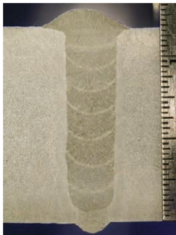
» Slika 2: Prečni prerez zvara cevi z zunanjim premerom 254 mm in debeline stene 31,75 mm.
