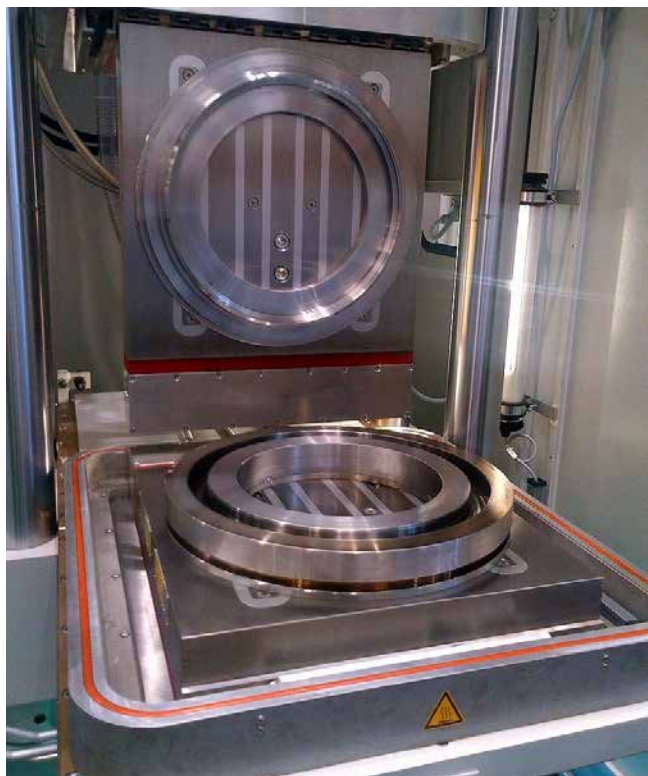
» Römheldova magnetna vpenjalna plošča Hilma M-Tecs na Wickertovi stiskalnici za gumo. (Kongres DTK, fotografija: Römheld)
