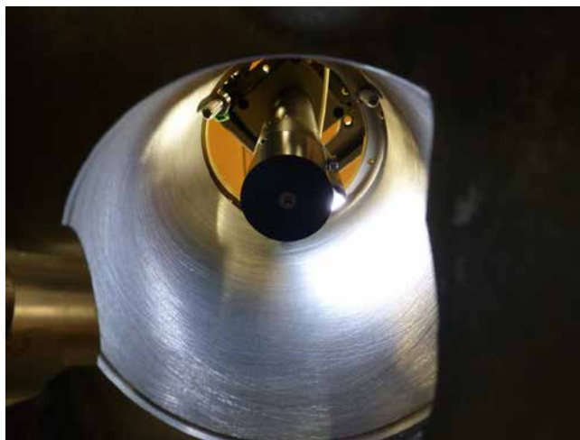
» Merilna glava CylinderInspector med pregledom notranjosti cilindra, ki površino osvetluje in jo meri brezkontaktno. To daje uporabnikom 360° panoramski pogled, ki se začne na točki po lastni izbiri. Sistem se centrirata neodvisno v območju premerov valjev 60-130 mm. Vir: Opto GmbH
