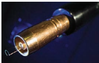
» Slika 1: SpinArc™ – Prikaz rotiranja žice, pri kateri nastane rotirajoči oblok.
