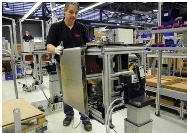
» Da bi bila površina vsebnika po obdelavi kar se da nepoškodovana, je bil razvit vpenjalni pripomoček s ščetinami na naslonski površini. (Slika: ROEMHELD).
