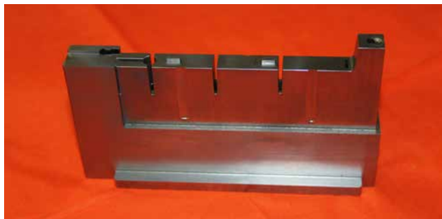
» Vložek štirignezdnega orodja za serijsko brizganje plastičnih pokrovov (dve gnezdi sta konvencionalne dvodelne lotane konstrukcije, dve pa izdelani s tehnologijo MPA)
