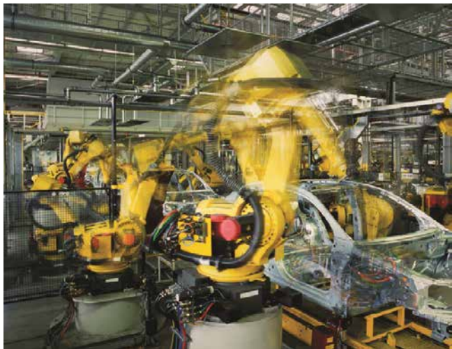
» Slika 1: Z uporabo novega varilnega postopka je varjenje pocinkanih pločevin bistveno olajšano [3].
