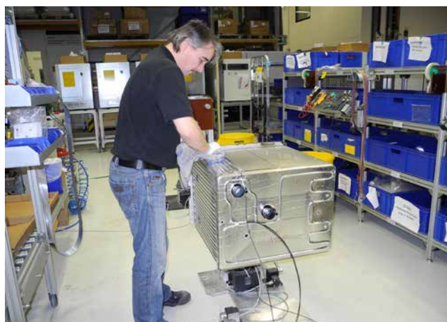
» V predmontaži oblepi sodelavec vseh pet strani z grelno folijo, pri tem pa mora vsebnik večkrat obračati (Slika: ROEMHELD).
