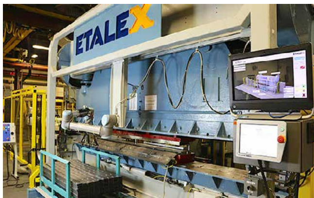
» UR10 iz Universal Robots odvzema kovinske dele iz stiskalnice pri kanadskem proizvajalcu Etalex iz Montreala. Namestitev UR10 je pripomogla, da je delovno mesto varnejše in proizvodnja optimalnejša, saj se je ob tem sprostilo sedem delovnih ur delavca na dan.
