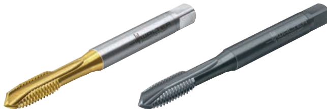
» Walter Prototyp TC216 za prehodne navoje do 3,5 x DN s TiN-prevleko in vaporizirano površino. Prevleka iz titanovega nitrida podaljša življenjsko dobo orodja, vaporizirano površino pa odlikuje dober nadzor odrezkov. / Slika: Walter AG
