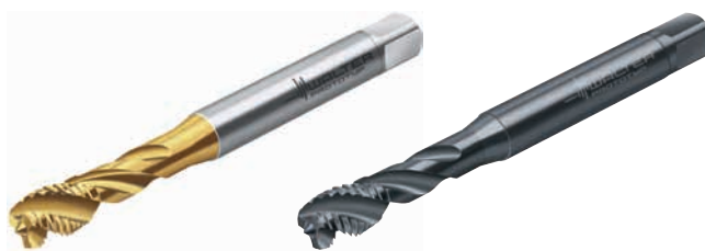
» Navojni sveder Walter Prototyp TC115 za slepe navoje do 3 x DN s TiN-prevleko in vaporizirano površino / Slika: Walter AG
