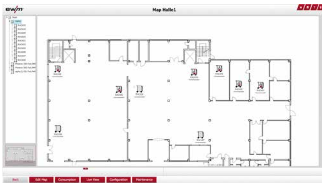
» Slika 6: Prikaz virov varilnega toka na načrtu tovarne.
