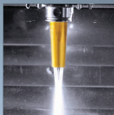
Jet Sleeve - koncentracija curka v območju rezanja
