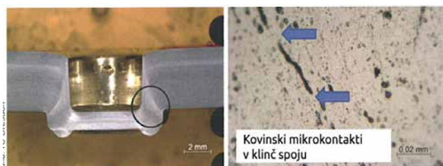
» Kovinski mikrokontakt v območju vratu klinč spoja Al-Al (Slika: TU Dresden)
