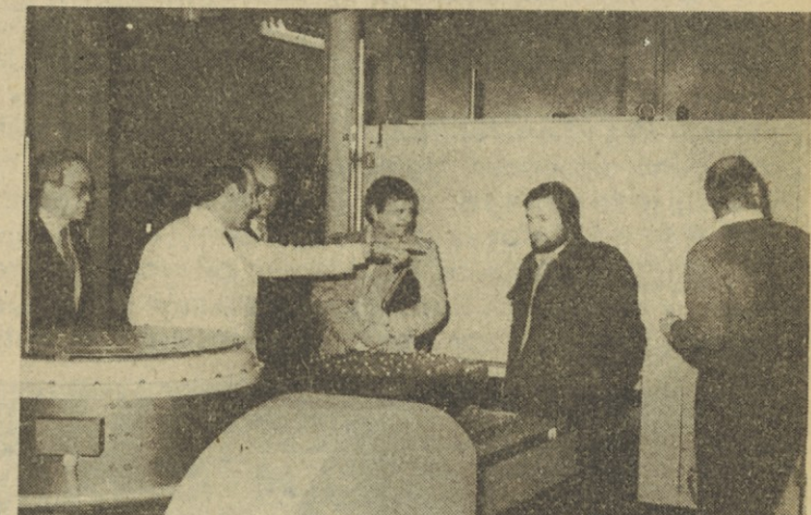
Delovanje novega sodobnega vibracijskega stroja s klimatsko komoro je razložil vodja oddelka za elektroniko Mitja Borko. Ta naprava omogoča kombinirano izpostavljanje temperaturnim spremembam, vlogi in vibracijam.
