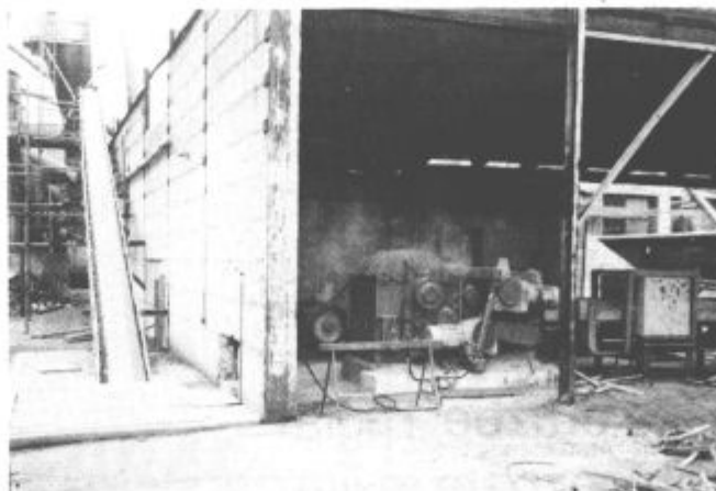
Velenjski ESO je izdelal nov sekač z mehanskim transportom sekancev
