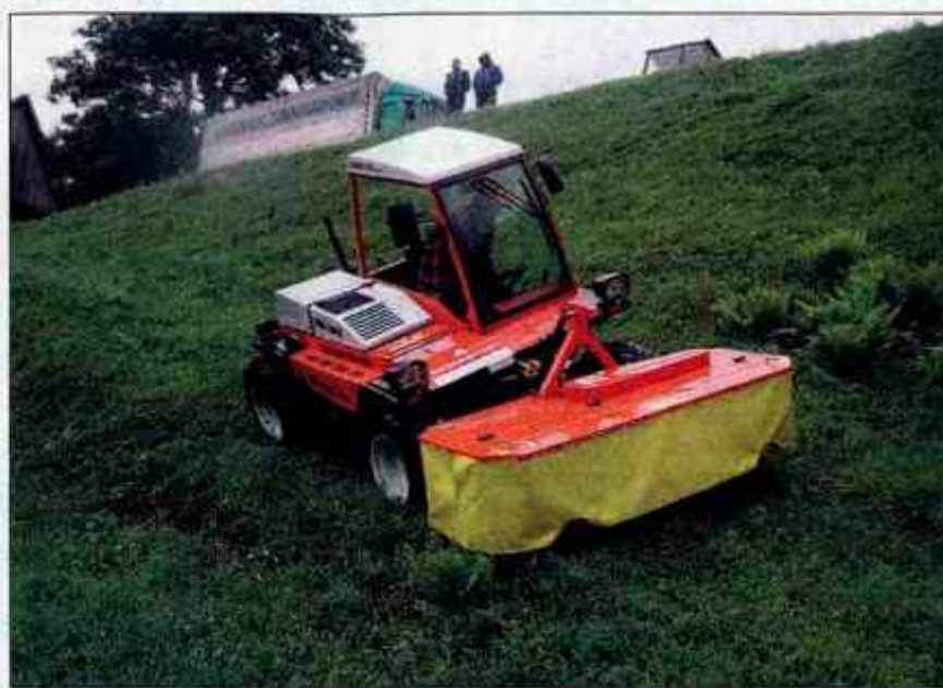
Gorski traktor Metrac s kosilnico med poskusom košnje v strmini. Tokrat zaradi razmočenega terena ni šlo.
