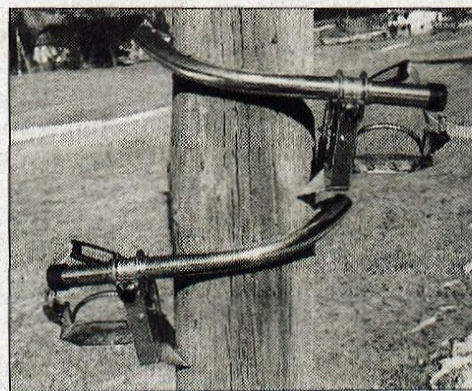
So revolucionarno drugačne od vseh ostalih plezalk, saj so regulacijske. Imajo poseben mehanizem, ki omogoča sprotno prilagajanje debelini droga.
