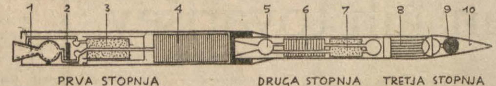
SL. 7. SHEMA TRIDELNE NOSILNE RAKETE (AMERIŠKI PROJEKT »VANGUARD«): 1 — GONILO PRVEGA DELA; 2 — ČRPALKA PRVEGA DELA; 3 — POSODA ZA GORIVOM PRVEGA DELA; 4 — POSODA ZA OKSIDANTOM PRVEGA DELA; 5 — GONILO DRUGEGA DELA; 6 — POSODA ZA OKSIDANTOM DRUGEGA DELA; 7 — POSODA ZA GORIVOM DRUGEGA DELA; 8 — TRDO GORIVO TRETJEGA DELA; 9 — UMETNI SATELIT; 10 — ZAŠČITNI STOŽEC. (NA SLIKI: PRVI DEL, DRUGI DEL, TRETJI DEL)
