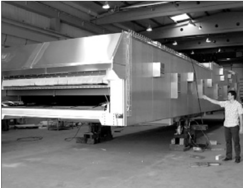
20 metrov dolga, 3 metre široka, 4 metre visoka in 33 ton težka peč FOTO KM.
